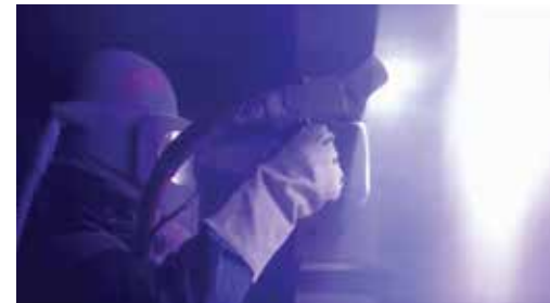
Revêtement par pulvérisation à base de zinc pour la protection contre la corrosion
