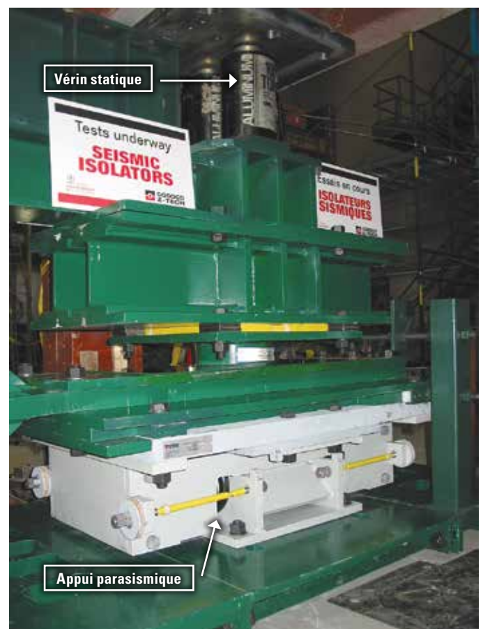
Figure 8 : Le système ZTS en essai dans un laboratoire indépendant.
